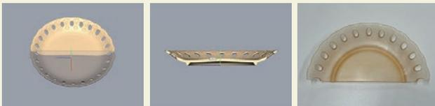
3) 3Dデータ変換ソフトを使いモデルを拡大。φ202mmの原型サイズは出力できないので半分ずつ出力
