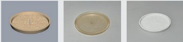
4) 樹脂原型を使用した試作品を作成。実際に使ったところ、金属製より陶磁器製の方が、使用感と味が実物に近いことがわかった。
