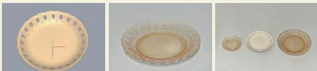
4) 3Dデータ変換ソフトを使いモデルをφ118mmに縮小し出力
