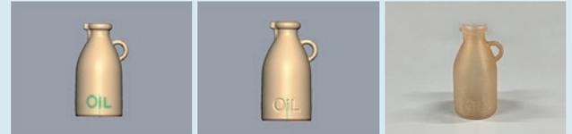
3) 3Dデータ変換ソフトのスタンプツールを使い凹文字を作成
