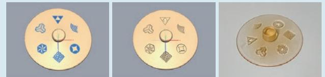
2) 3Dデータ変換ソフトのスタンプツールを使い凹文字を作成
